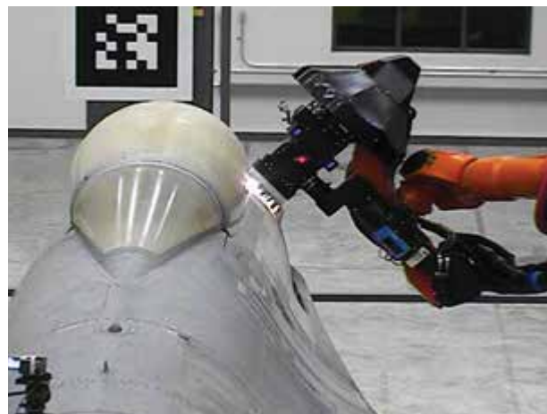
Рисунок 37 – Пример удаления покрытия с изделия с помощью лазера
