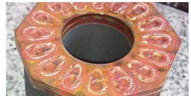
Рисунок 27 – Пример лазерной сварки глубоким проплавлением
