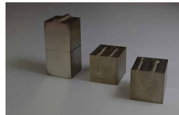
Рисунок 31 – Пример детали, полученной с помощью лазерной сварки толстого металла
