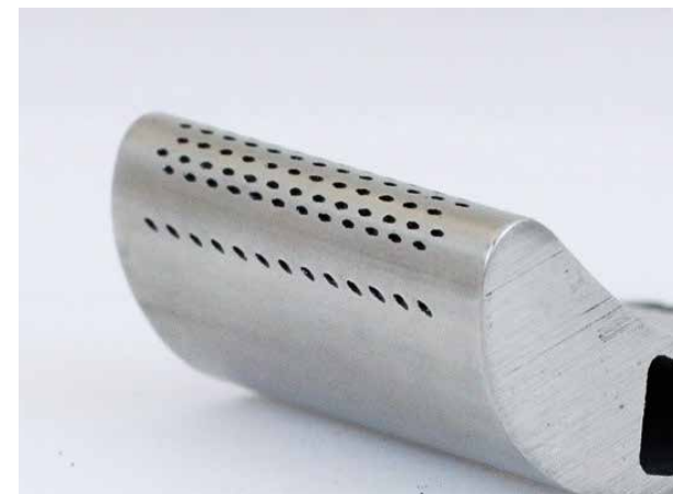
Рисунок 20 – Пример детали, полученной с помощью лазерного сверления
