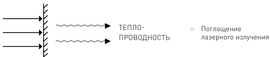
Рисунок 4 – Принципиальная схема поглощения лазерного излучения
