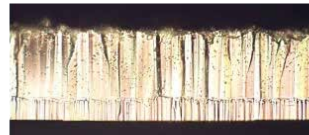
Рисунок 47 – Пример лазерного скрайбирования пластин карбида кремния
