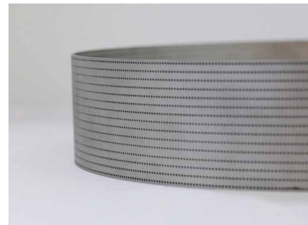
Рисунок 21 – Пример детали, полученной с помощью лазерного сверления
