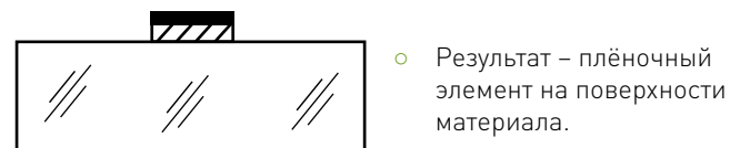
Рисунок 15 – Результат локального лазерного окисления и травления – плёночный элемент на поверхности материала
