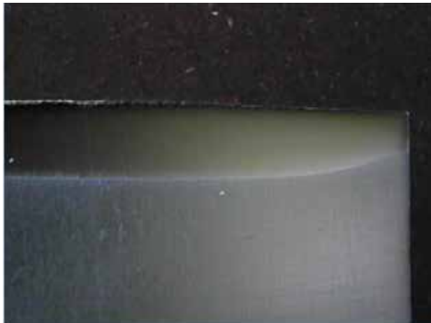
Рисунок 38 – Поперечное сечение вала, упрочнённого (закалённого) с помощью лазера
