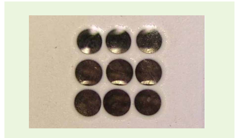
Рисунок 8 – Пример аморфизации (формирования линзового растра) пластины ситалла 9 СТ-50-1
