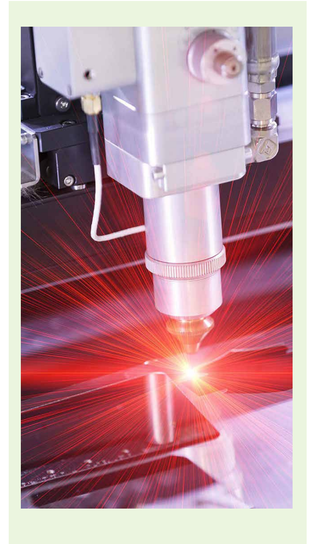
Рисунок 55 - Сверление отверстий диаметром 1 мкм в стекле
