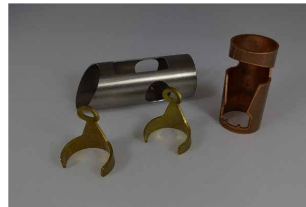
Рисунок 17 – Пример деталей, полученных с помощью лазерной резки из трубных заготовок
