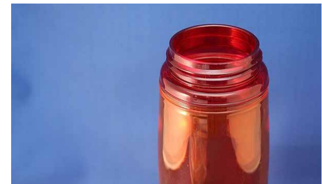
Рисунок 33 – Пример детали, полученной лазерной сваркой разных полимеров
