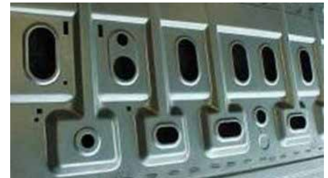
Рисунок 26 – Пример лазерной точечной сварки
